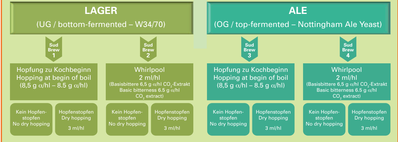
Abb. 3 Sudschema der weiterführenden Sudversuche
