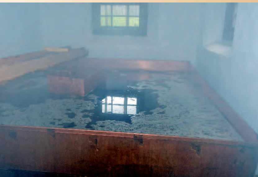
Zum Schluss wird die Flüssigkeit über eine Rinne ins **Kühlschiff** geleitet, wo sie abkühlt.
