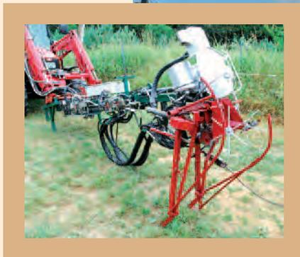
Im Bereich Hopfentechnik wurden verschiedene Geräte vorgeführt. Im Bild die automatische Drahtaufhängung im Einsatzbetrieb. Die ausgeklügelte Technik spart Manpower und Zeit.
