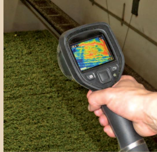
Trocknungsluft abgeführt wird. Bei einer stärkeren Abkühlung der Darrabluft kommt es zur Kondenswasserbildung mit der Folge, dass sich die äußere Qualität verschlechtert und die Trocknungsleistung stark verringert.
