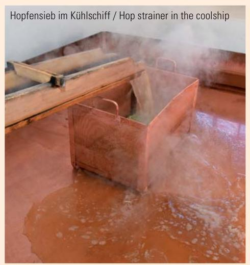
Hopfensieb im Kühlschiff / Hop strainer in the coolship
