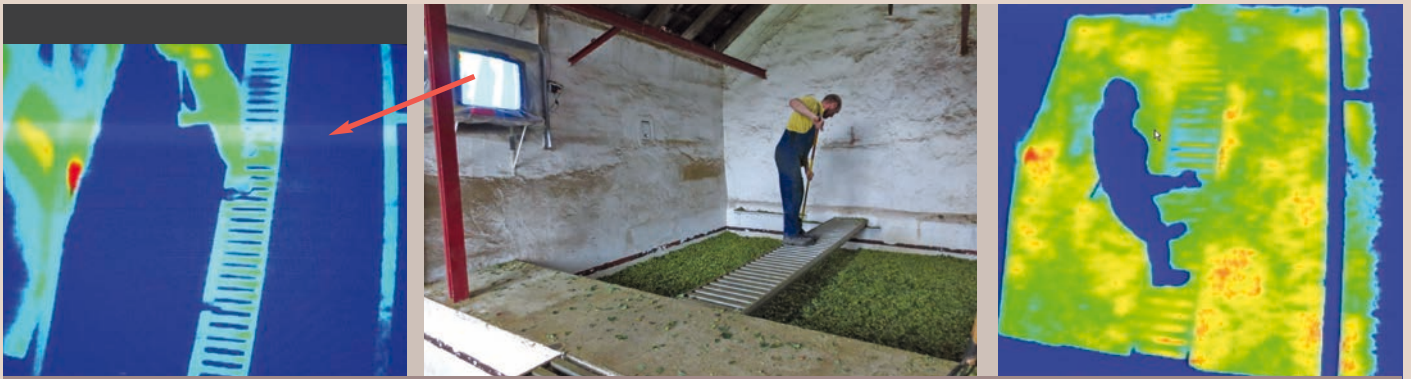
Abbildung 5: Kontrolle auf gleichmäßige Schüttdichte nach dem Befüllen der Aufschütthorde und auf Gleichmäßigkeit während der Trocknung Figure 5: Checking for uniform layer density after filling the top floor and for consistent drying
