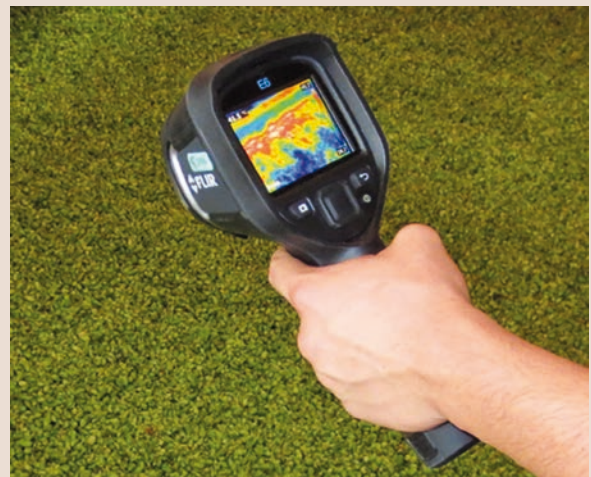
Abbildung 3: Kontrolle auf gleichmäßige Abtrocknung mit einer Wärmebildkamera als Handgerät
