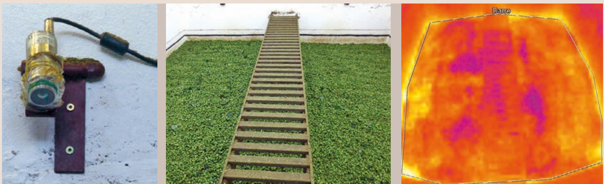
Abbildung 4: Wärmebildkamera, Messfläche über der Aufschütthorde, zugehöriges Wärmebild
