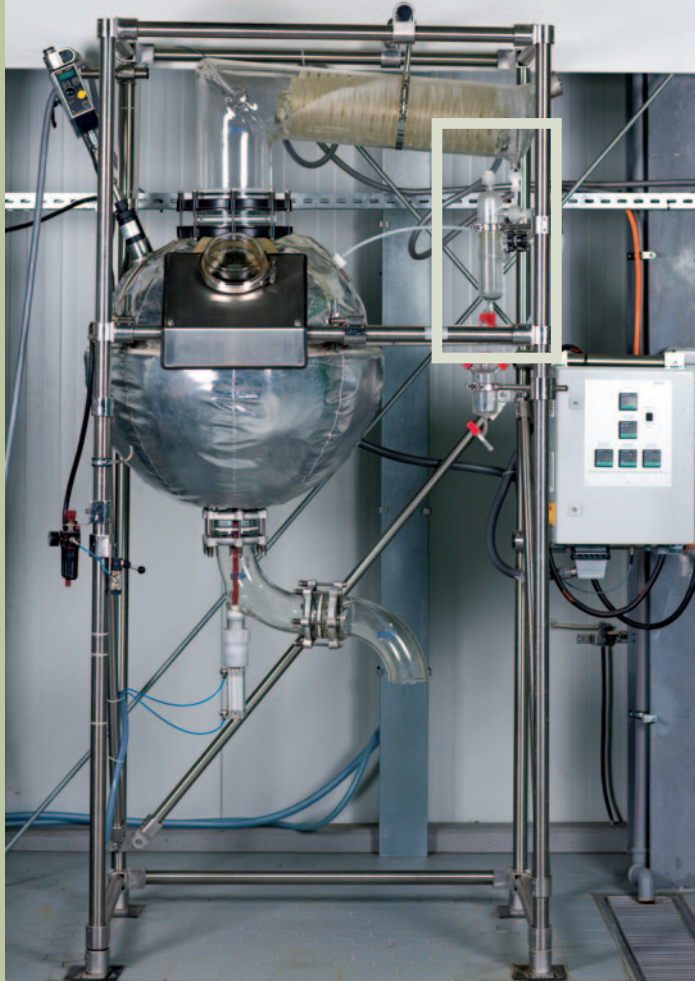
Abbildung 2: Apparatur zur Isolierung des etherischen Öls aus Hopfen mit Detailansicht auf der rechten Seite
